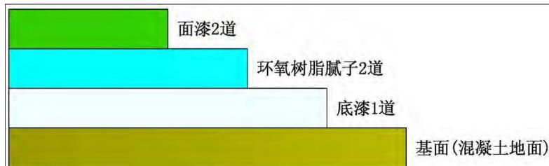
图 6.4-1 环氧地坪结构示意图
